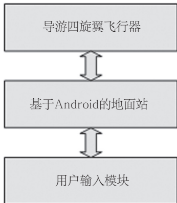
图1 导游无人机机构图
